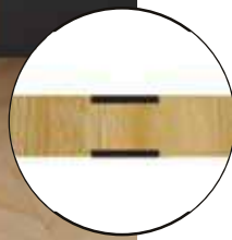
Sklo lacobel vlepene do hdf dosky (6mm hrubá hdf). Zarovnané s povrchom krídla.
